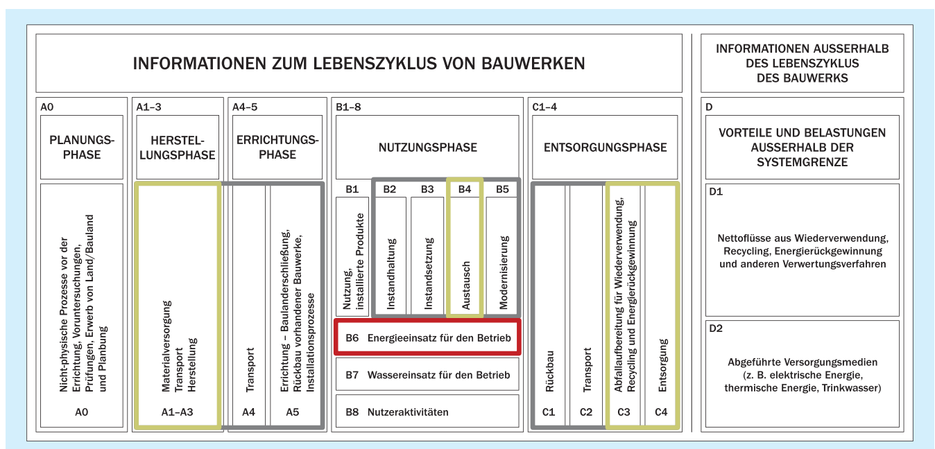
Bild 13 Module der Ökobilanzierung von Bauwerken: unabdingbar sind für die herstellungsbedingte Betrachtung die Module A1-3, B4 und C3-4, für die betriebsbedingten das Modul B6
