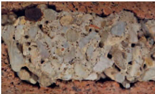
Bild 30 Früherer Beton hatte üblicherweise eine stark poröse Struktur und wies einen (sehr) geringen Feuchtgeschutz auf
