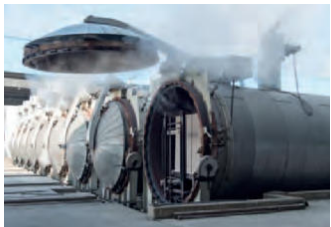
Bild 5 Das Härten der Rohlinge erfolgt in Dampf-Härtekesseln
