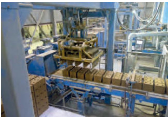
Bild 4 Nach dem Mischen werden die Rohlinge gepresst
